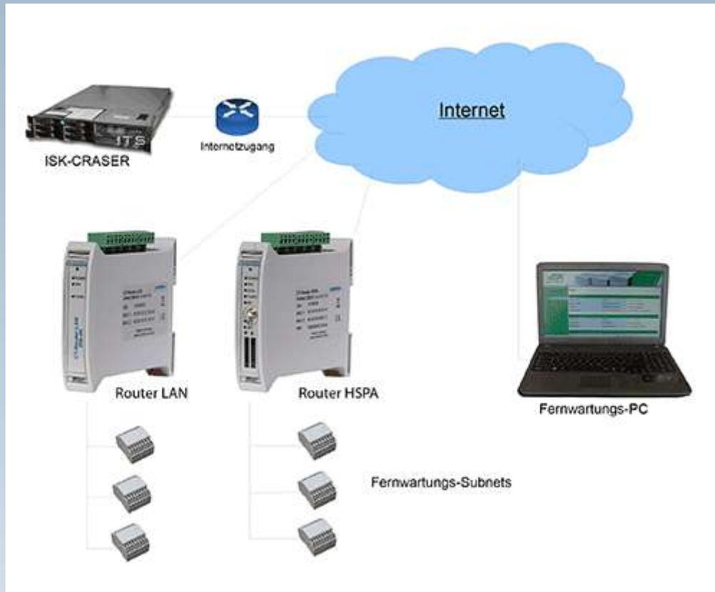
In diesem Beispiel werden 2 Subnetze und ein Fernwartungs-PC über den ISK-CRASER gekoppelt. Der Fernwartungs-PC kann sowohl auf das gesamte LAN1-Subnetz des HSPA-Router zugreifen als auch auf das gesamte LAN1-Subnetz des LAN/WAN-Router. Die Zugriffsrechte im ISK-CRASER lassen sich auch so konfigurieren, dass HSPA-Router und LAN/WAN-Router untereinander auf ihre LAN1-Subnetze zugreifen können. Somit sind neben Fernwartungsaufgaben auch allgemeine Automatisierungsaufgaben lösbar.
